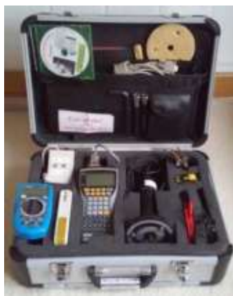
Rys. 1.2. Elementy zestawu pomiarowego stosowanego w metodzie impulsu galwanostatycznego
